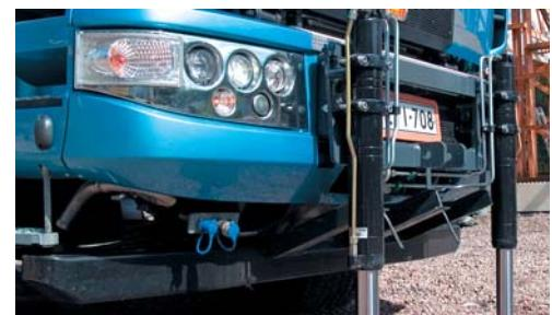
Плита крепления передних опорных стоек крана, усиление конструкции рамы, места крепления опорных стоек – все установлено сразу на заводе, таким образом, не нужно впоследствии разбирать шасси и производить усиление конструкции рамы.
