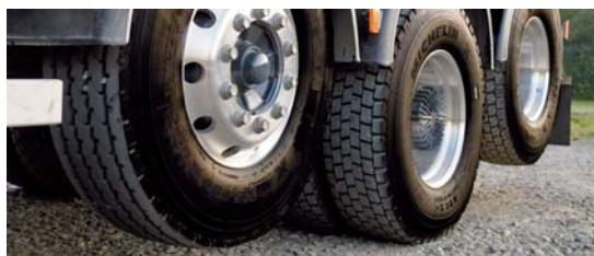
При заказе автокрана SISU Crane можно выбрать различные варианты колесной формулы: традиционная подъемная тележка Sisu (8x2) или ведущая подъемная тележка Sisu (8x4 или 10x4). Технические решения в конструкции осей и мостов обеспечивают беспроblemное транспортное хранение и монтажные работы, а подъемная тележка делает автомобиль более маневренным и легким в управлении даже в стесненных местах.
