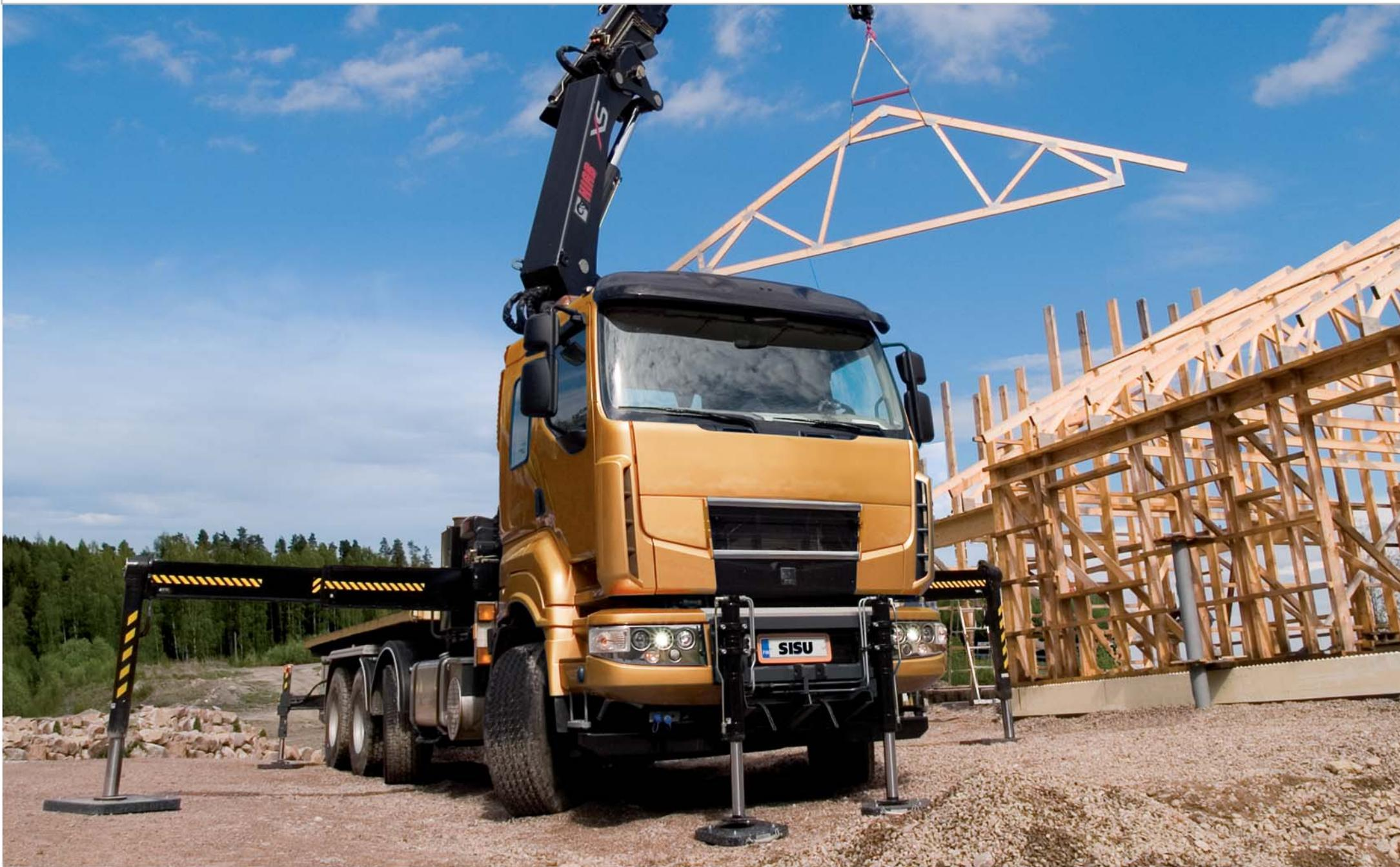
SISU Crane – самый многогранный автокран на рынке спецтехники. SISU Crane изготавливается на заводе полностью готовым к работе и в соответствии с пожеланиями клиента. И что самое важное – зона работы SISU Crane с грузами при сохранении полной подъемной мощности составляет 360 градусов, что несравненно расширяет эксплуатационные возможности. Полный груз можно поднимать и прямо спереди автомобиля.
